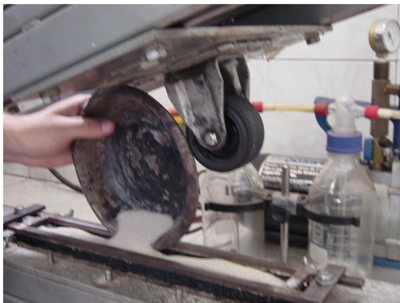
Figura 9 – Colocação da areia no corpo-de-prova.
