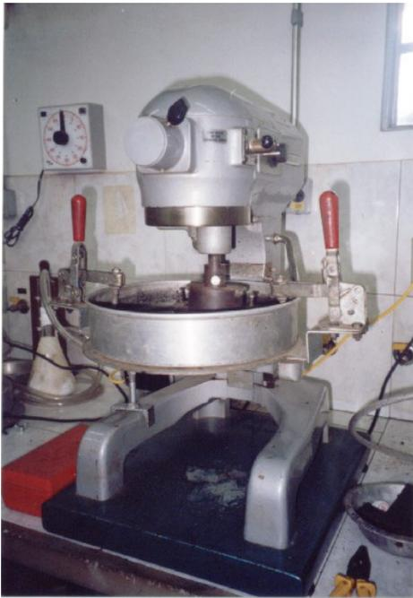
Figura 4a – Equipamento do ensaio de perda por abrasão úmida.
