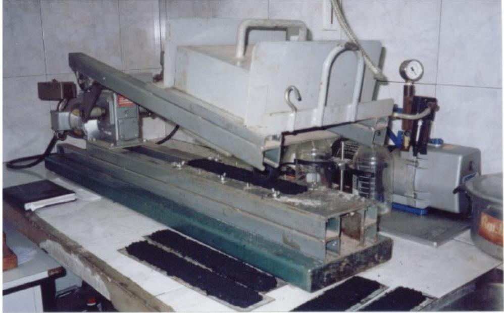
Figura 5 – Equipamento LWT operação.
