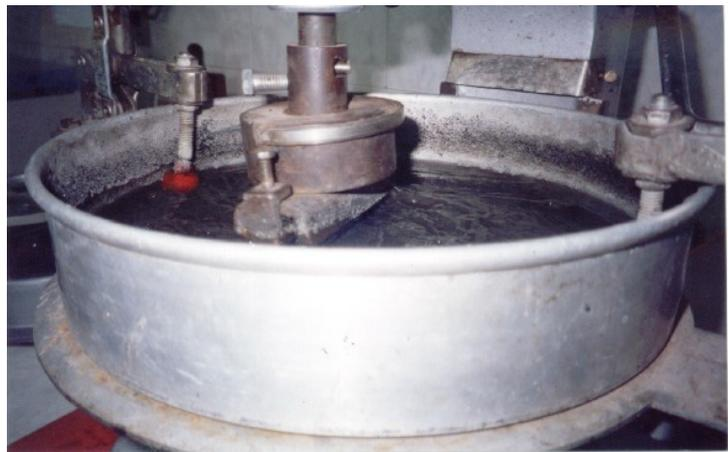
Figura 4b – Detalhe do equipamento do ensaio de perda por abrasão úmida.
