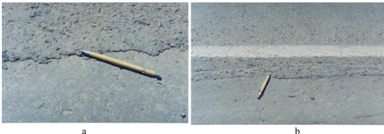
Figura 21 – (a) Espessura do MRA com adição de resíduo ; (b) detalhe da camada de MRA sobreposta na pista.
