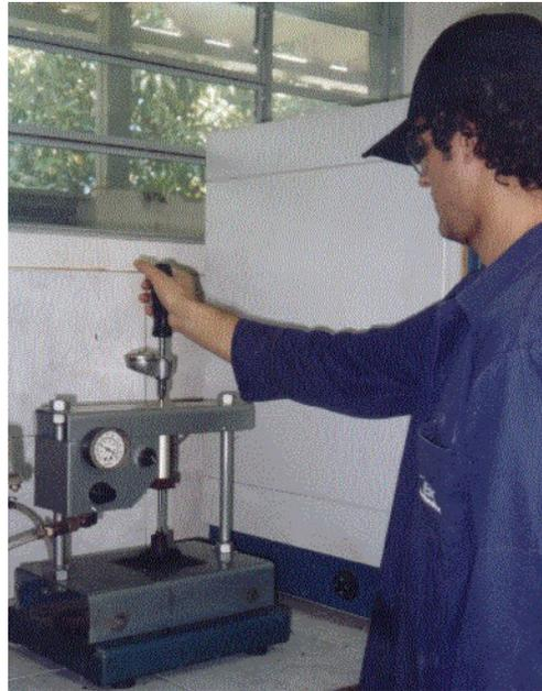
Figura 11 – Equipamento coesímetro.
